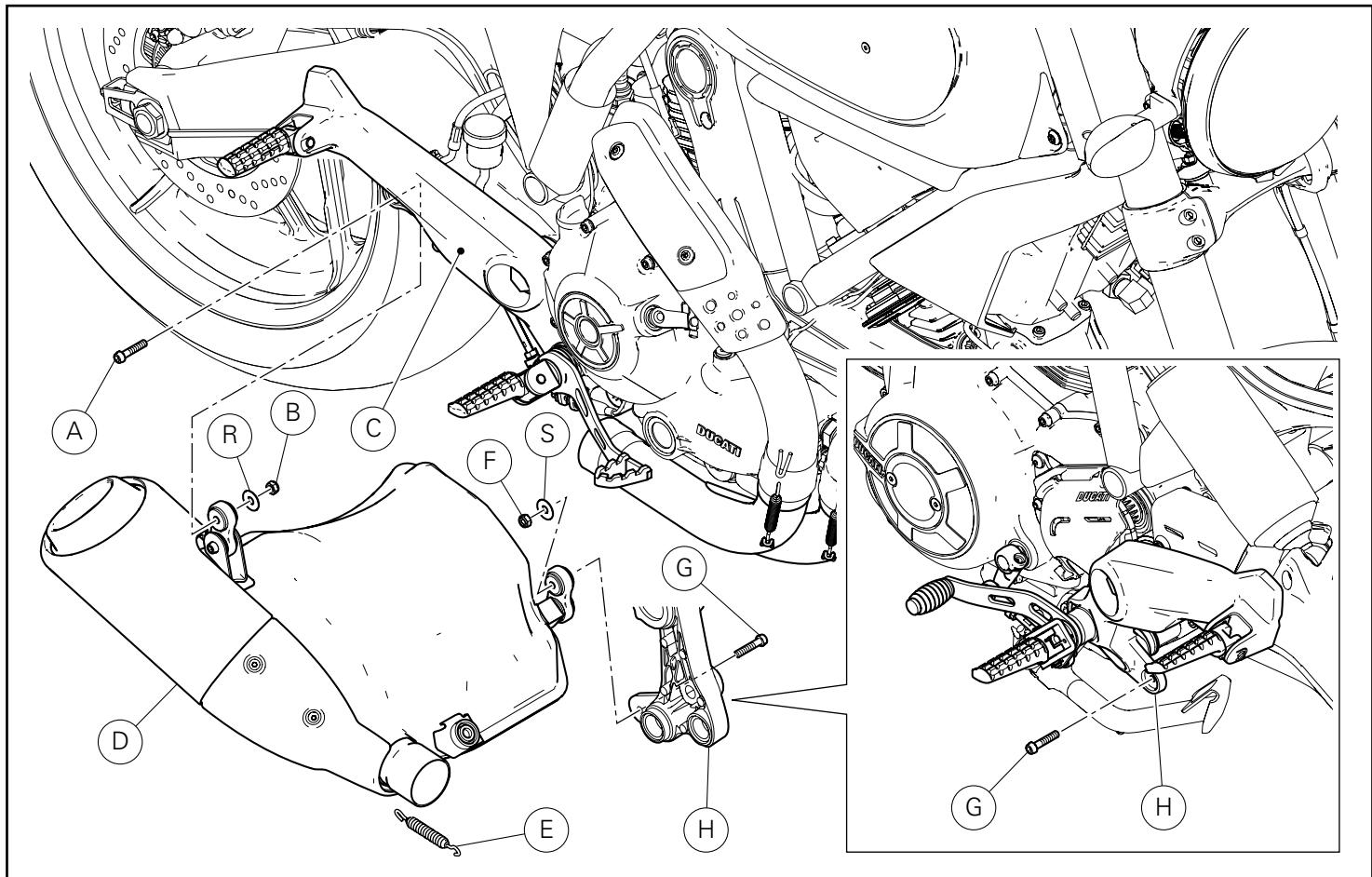
En agissant du côté gauche de la moto, desserrer la vis (G) de fixation de l'ensemble silencieux (D) à la plaque support repose-pied gauche (H) en tenant l'écrou (F) du côté opposé.
