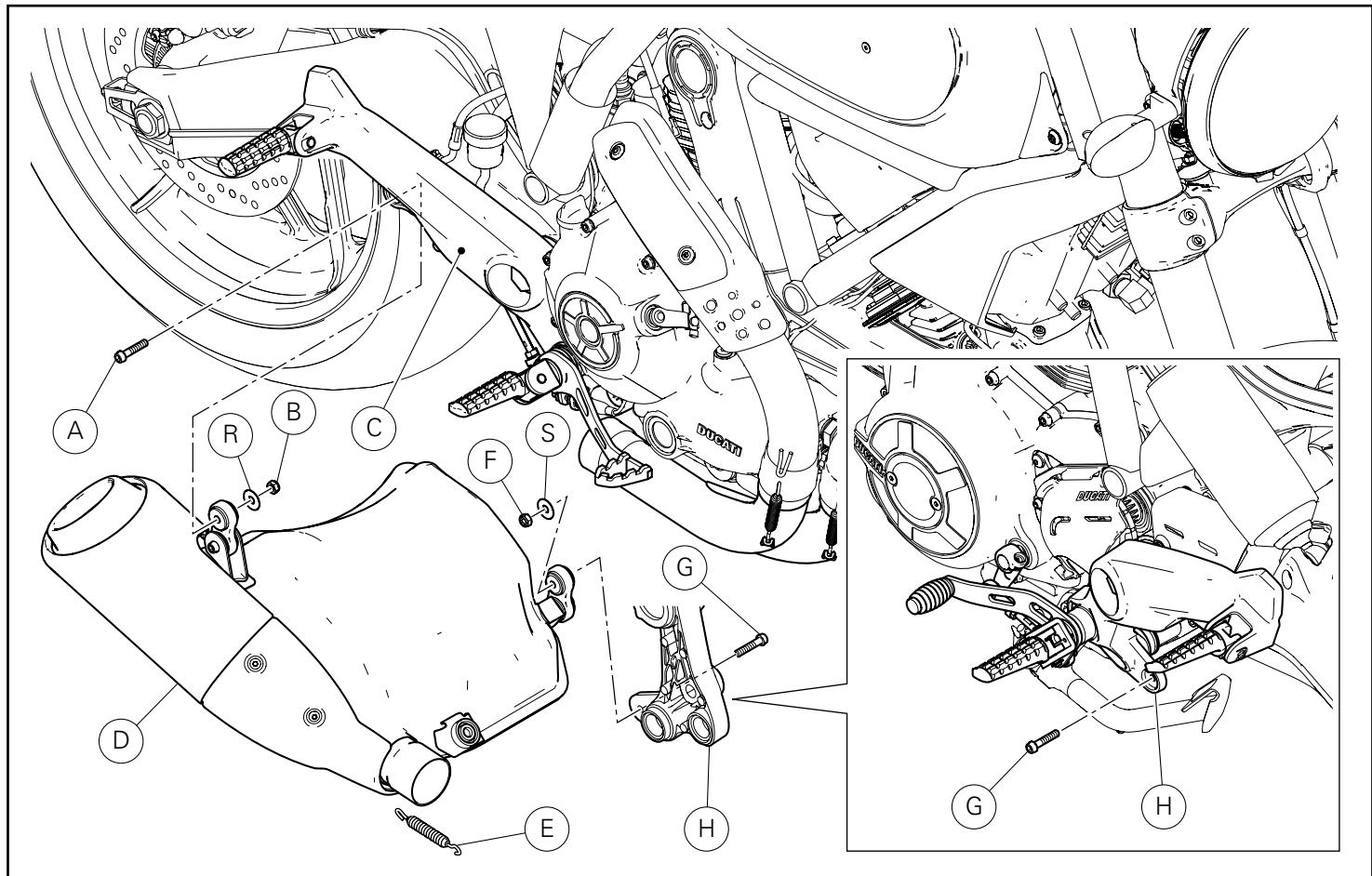
Operando del lado izquierdo de la motocicleta, desatornillar el tornillo (G) que fija el grupo silenciador (D) a la placa porta estribo izquierda (H) bloqueando del lado opuesto, la tuerca (F). Quitar la tuerca (F) y la arandela (S).
