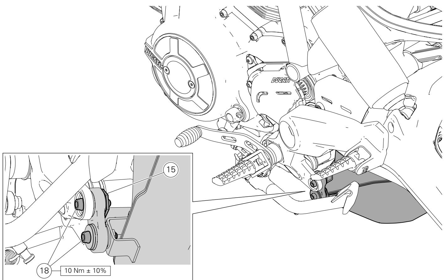
En agissant du côté gauche du motocycle, serrer la vis inférieure (18) au couple prescrit.
