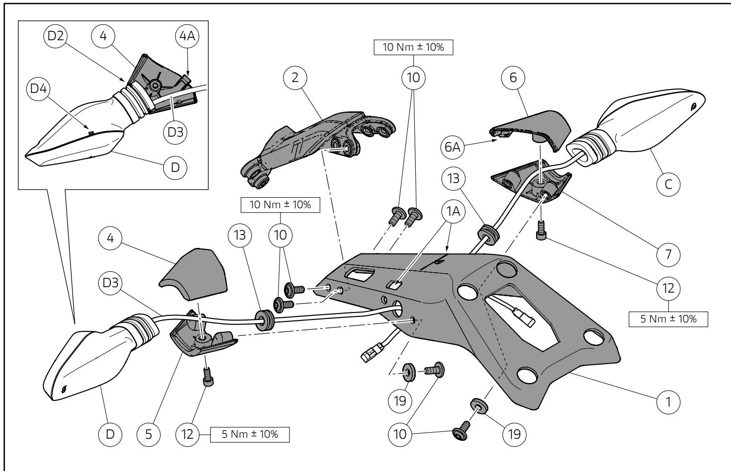
Montare il gommino antivibrante (13) sul supporto portatarga (1). Introdurre la rosetta (19) sulla vite (10). Posizionare i semigusci premontati sul supporto portatarga (1), inserendo il dente (4A) nell'assola (1A). Sul lato interno del supporto portatarga (1), impuntare la vite (10) sul foro anteriore.
