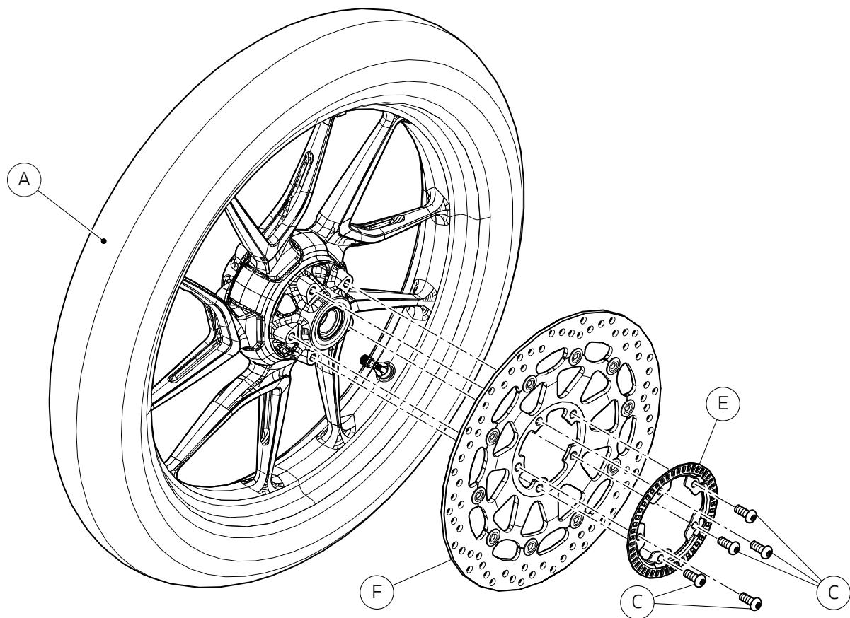
Operando sul lato destro della ruota anteriore (A), svitare le n.5 viti (C). Rimuovere e conservare la ruota fonica anteriore (E) e il disco freno anteriore destro (F).
