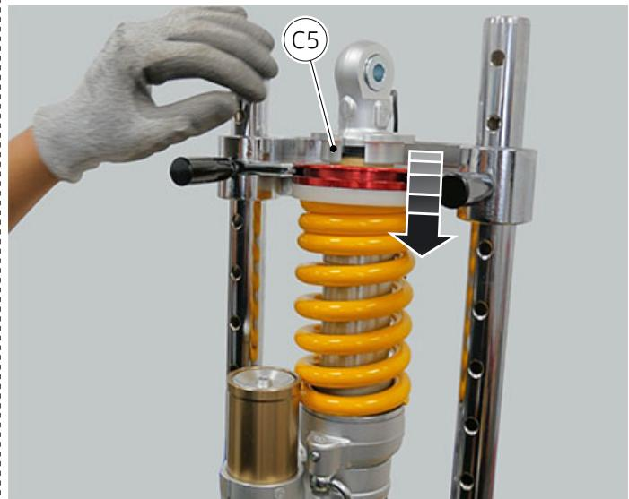
Prima di montare l'ammortizzatore posteriore (C) sull'attrezzo smontamolla inserire il cablaggio all'interno del distanziale (G) per non schiacciarlo durante il montaggio.
