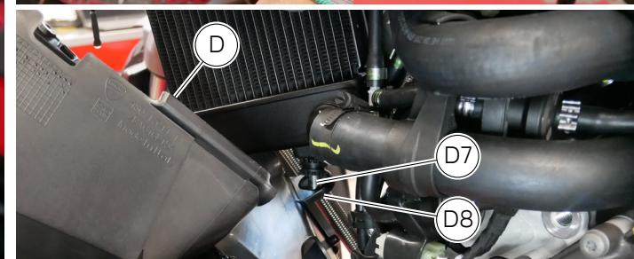
Sfilare la struttura ala sinistra (D) sfilando le n.2 alette (D3). Liberare gli agganci (D4) dalle asole (D5). Scalzare i cavi (D6) e sfilare l'asola (D8) dal perno (D7) del radiatore.
