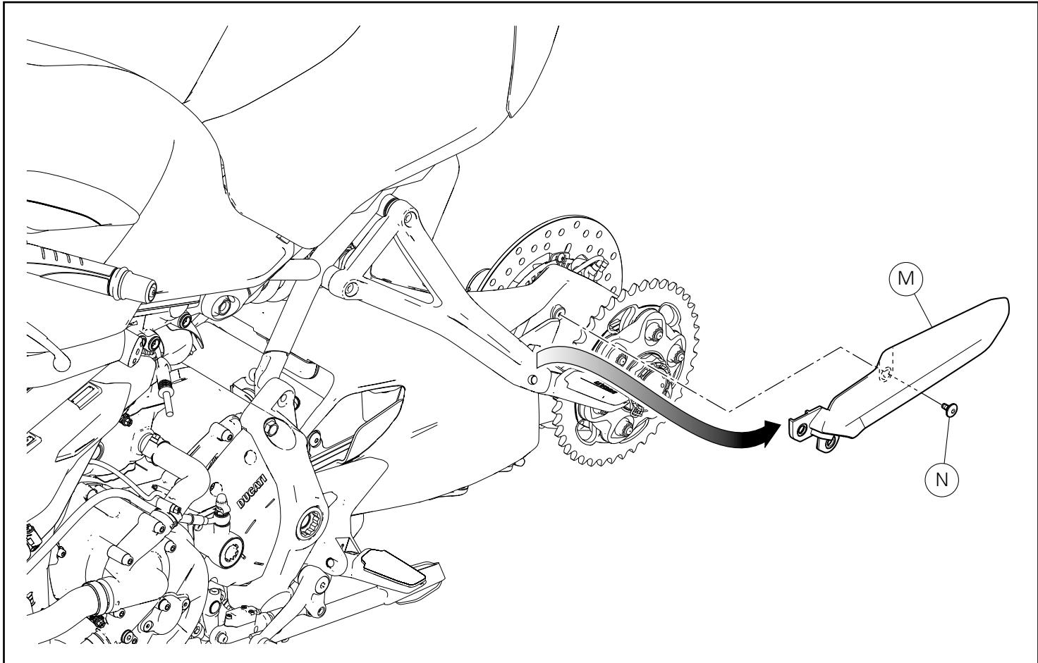
Desatarraxe o parafuso (N) e retire o protetor de corrente (M).
