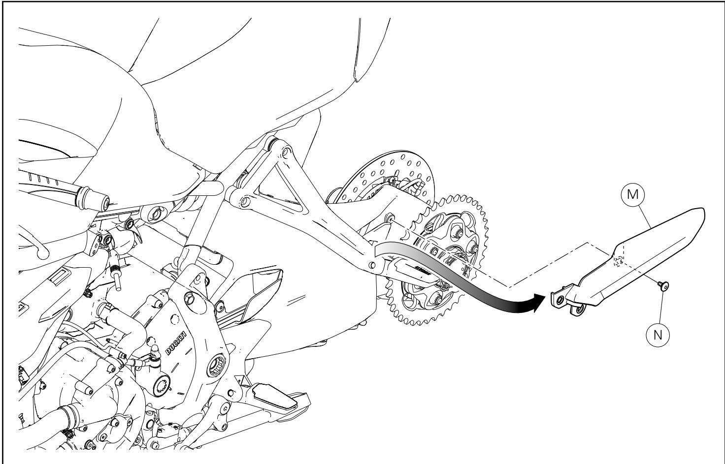
Desserrer la vis (N) et sortir le cache-chaîne (M).
