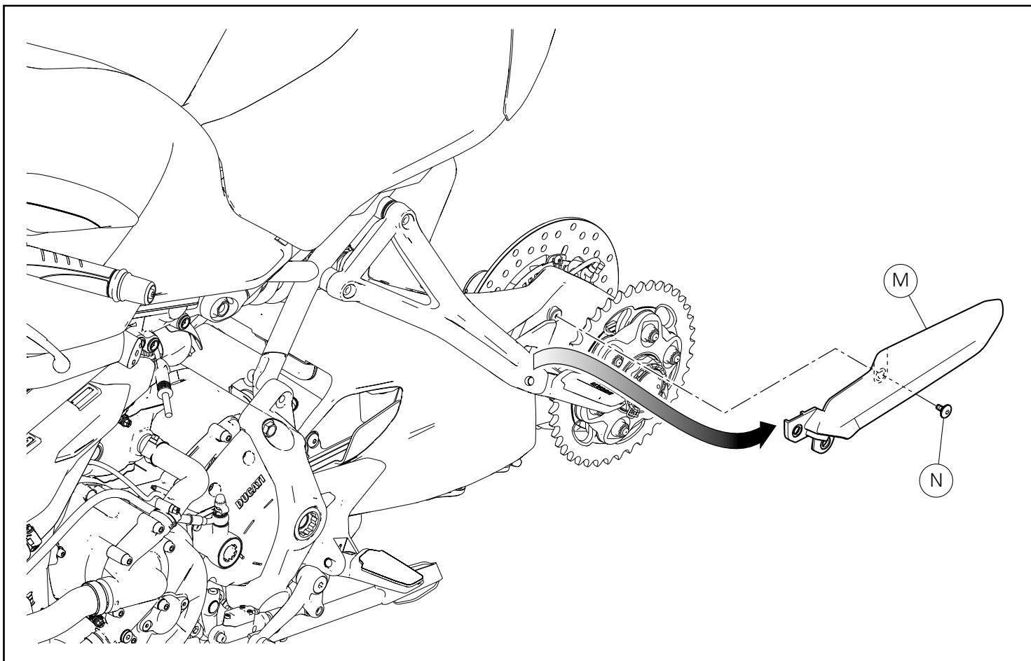
Svitare la vite (N) e sfilare il paracatena (M).
