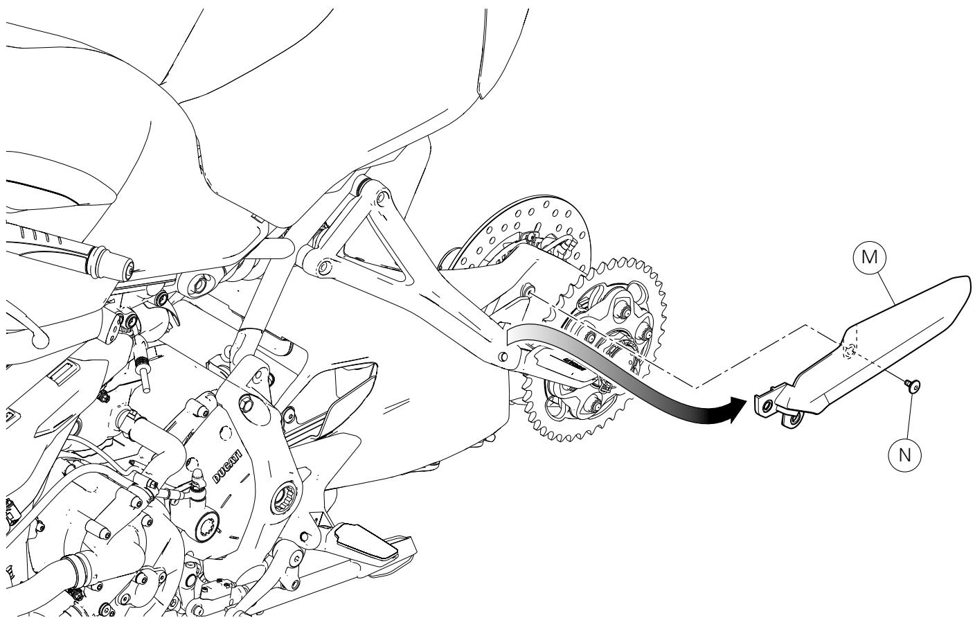
Desatornillar el tornillo (N) y extraer el protector cadena (M).
