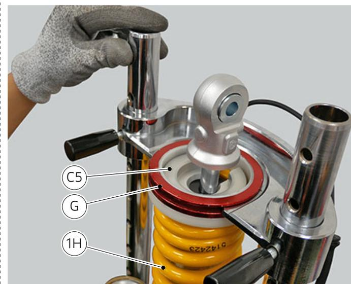
Montare la molla ribassata (1H) sull'ammortizzatore posteriore (C).
