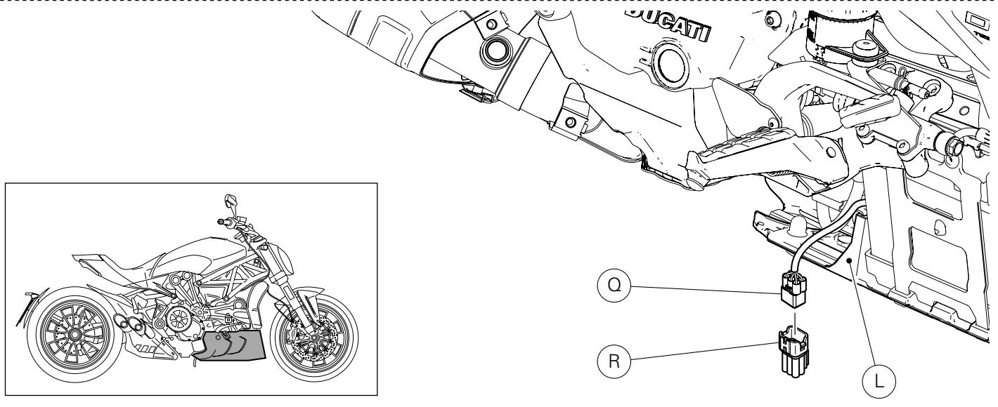
Dépose ensemble actionneur vanne à l'échappement
