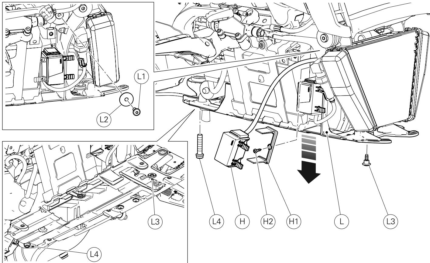
Dépose support des composants électriques
