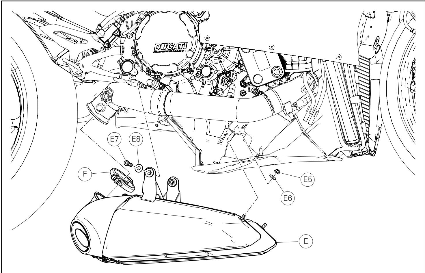
Svitare il dado (E5) con rosetta (E6) di fissaggio anteriore del silenziatore (E).
