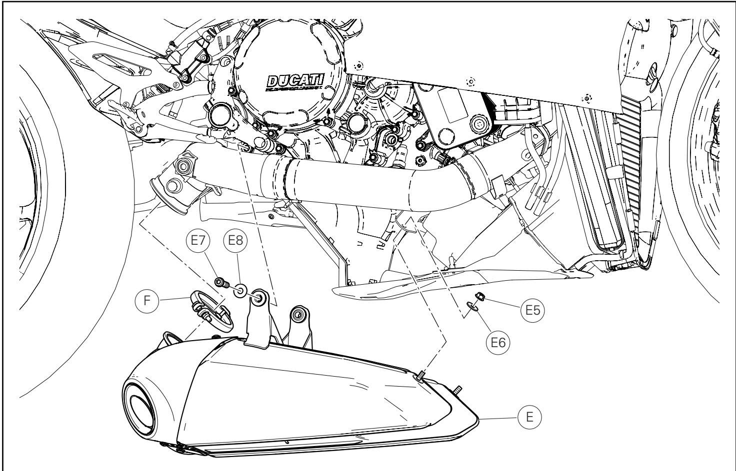
Desatornillar la tuerca (E5) con arandela (E6) de fijación delantera del silenciador (E).
