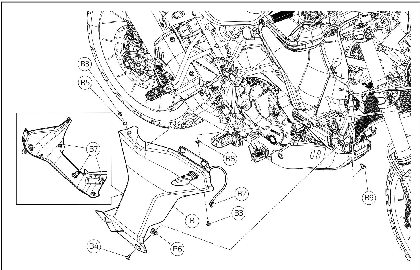
Svitare e rimuovere le n.2 viti (B3). Tenendo bloccata la boccola filettata (B9) svitare e rimuovere la vite (B4). Rimuovere la carena anteriore destra (B) sganciando i n.4 perni (B7). Recuperare la rosetta (B5). Recuperare la clip (B8). Recuperare il gommino (B6). Recuperare la boccola filettata (B9).
