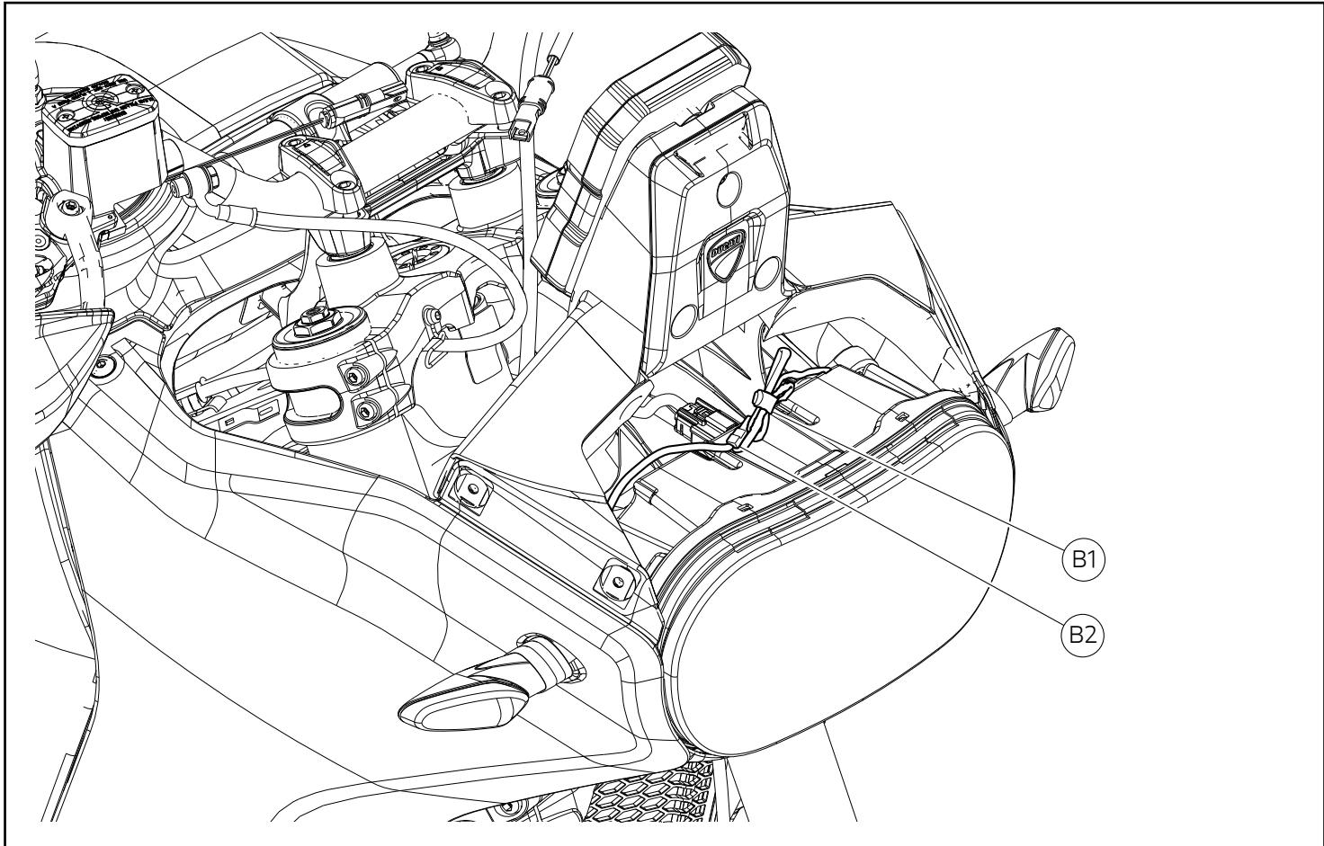
Collegare il connettore indicatore di direzione anteriore destro (B2). Ripristinare la fascetta in gomma (B1).
