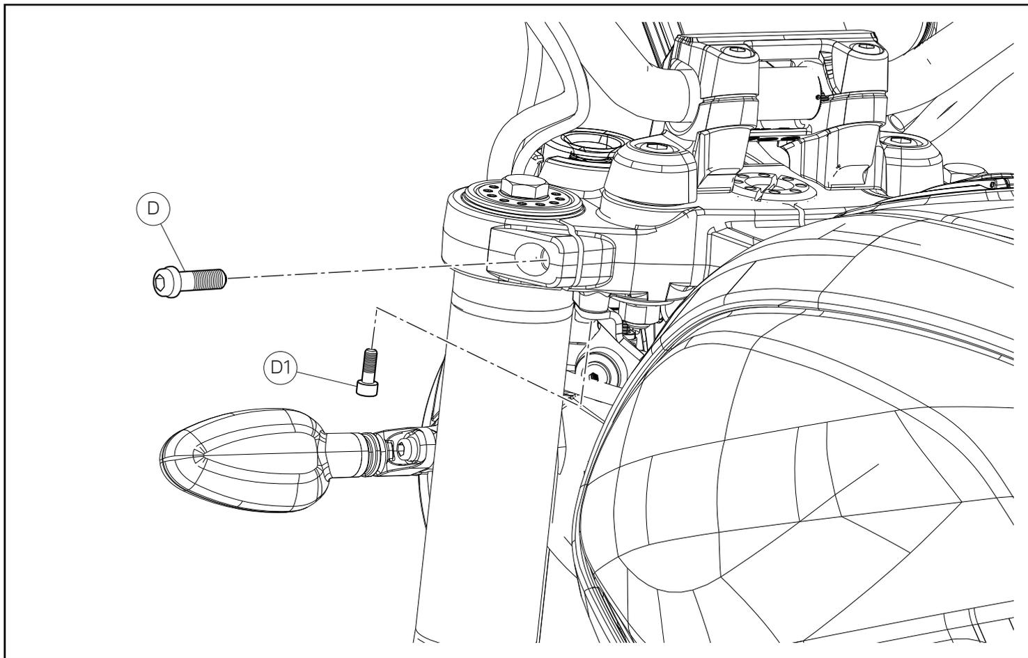
Operando sul lato sinistro del motoveicolo svitare la vite (D) e la vite (D1).
