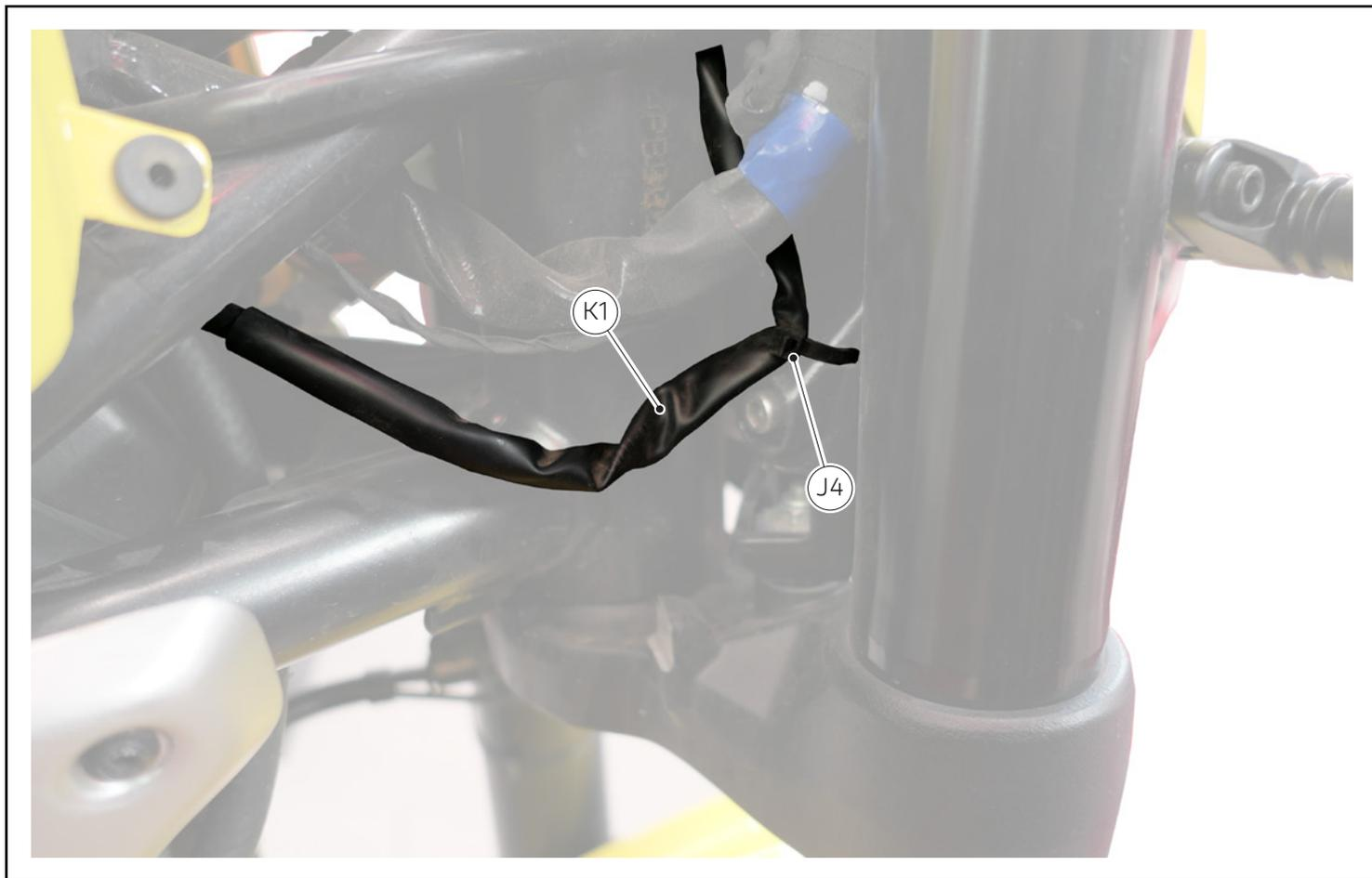
Rimuovere la fascetta in nylon (J4) e sfilare il cavo (K1) della manopola del gas.
