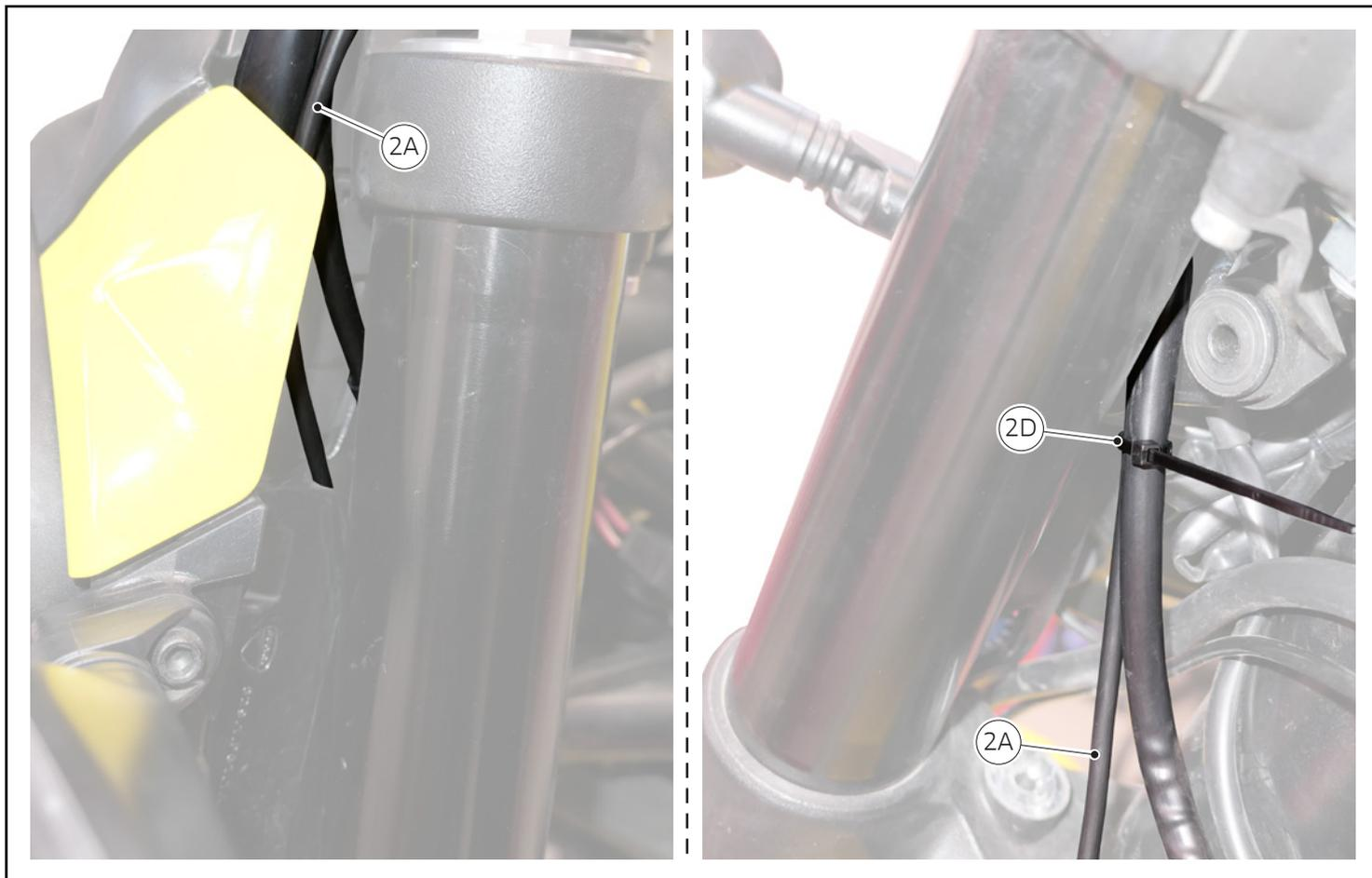
Far passare il cavo (2A) dietro il gruppo faro. Operando sotto la testa della forcella anteriore fissare il cavo (2A) con una fascetta in nylon (2D).
