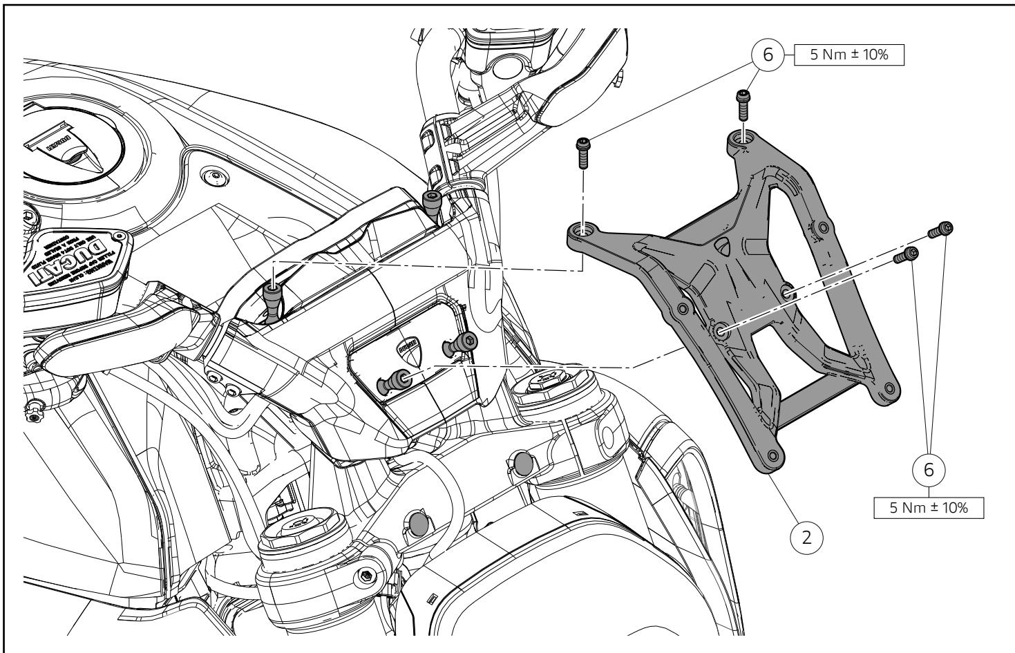
Posizionare la staffa (2), centrando i fissaggi con le n.4 viti (5) appena installate. Impuntare le n.4 viti (6). Serrare le n.4 viti (6) alla coppia indicata, per il fissaggio della staffa (2).
