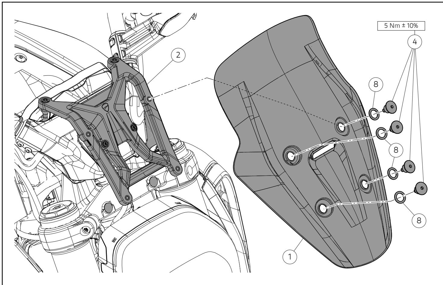
Posizionare il cupolino (1) sopra la staffa (2). Inserire le n.4 rondelle (8) sul filetto delle n.4 viti (4). Impuntare le n.4 viti (4). Serrare le n.4 viti (4) alla coppia indicata.
