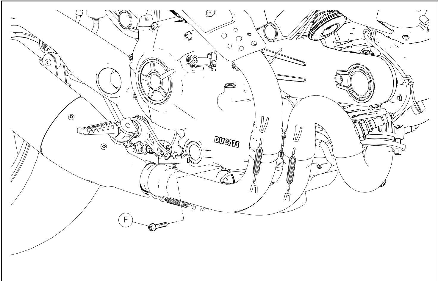
En intervenant du côté droit du motocycle, desserrer la vis (F) de fixation du couvercle d'embrayage.
