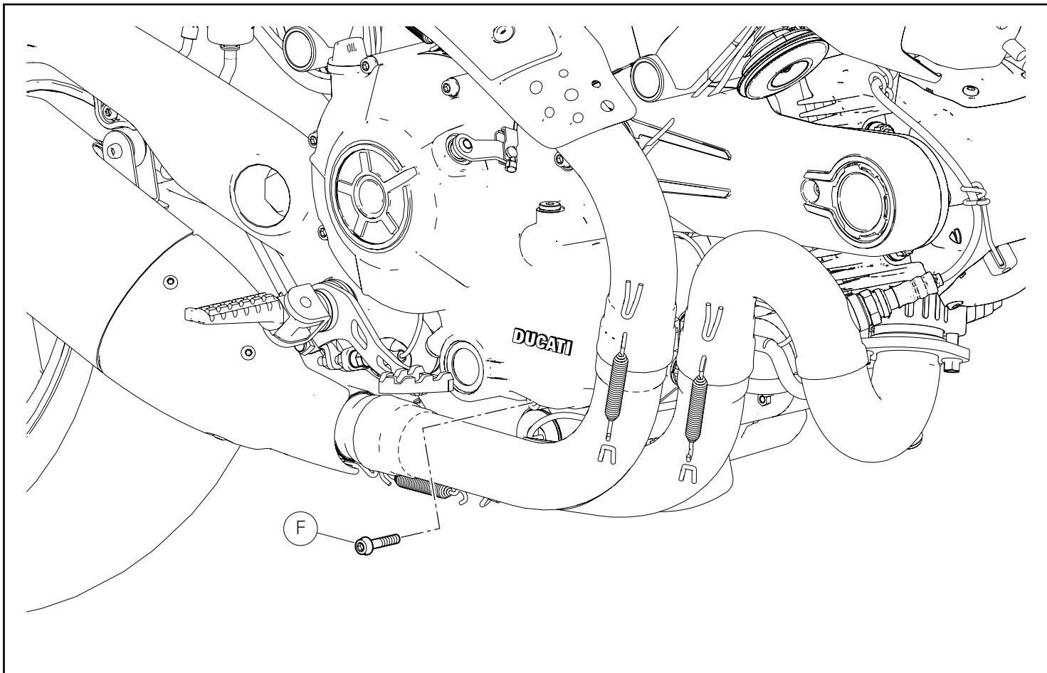
Operando dal lato destro del motoveicolo, svitare la vite (F) di fissaggio del coperchio frizione.
