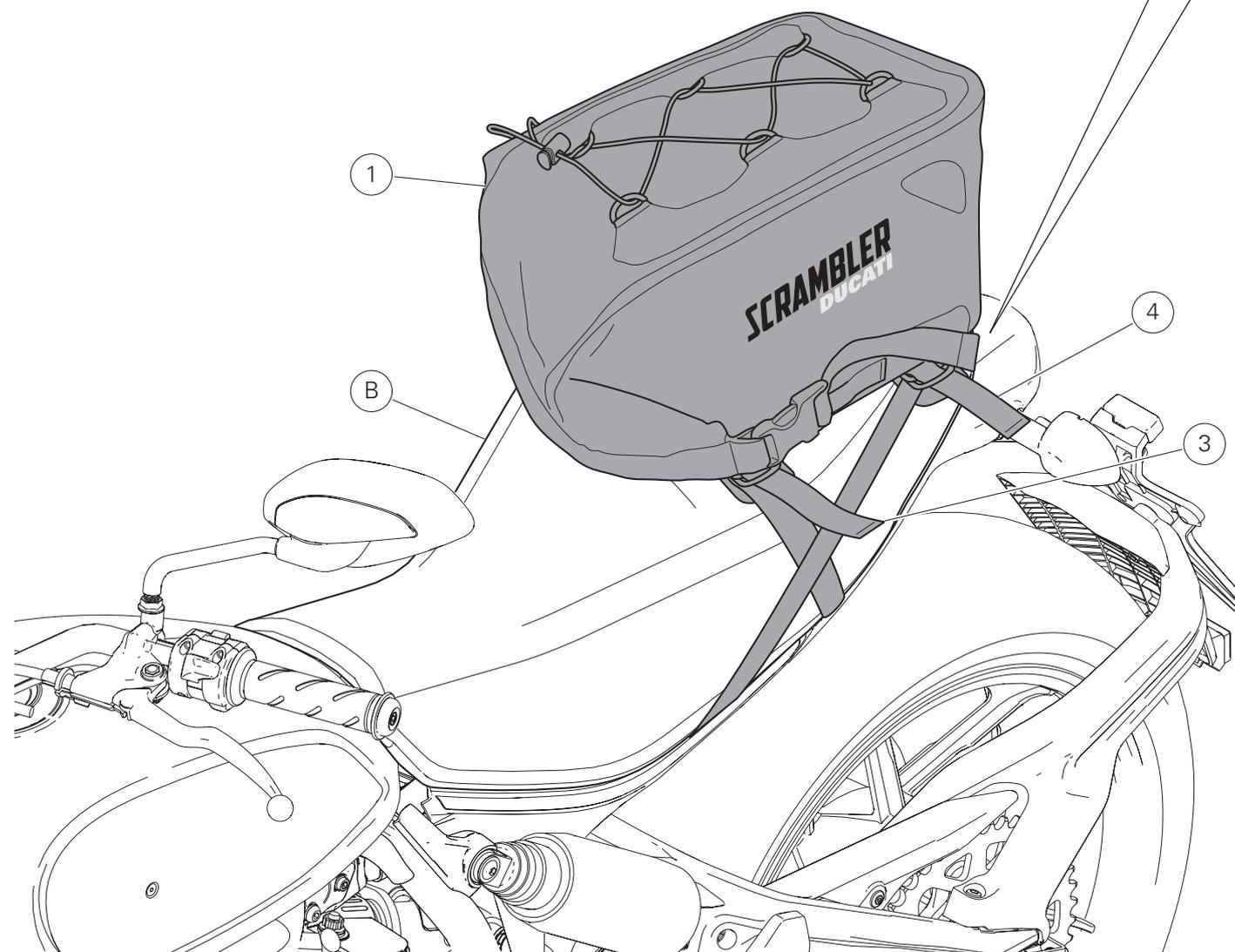
Appuyer le sac de selle (1) sur la selle (B) dans la position correcte. Fixer le sac de selle (1) en insérant les courroies de sécurité courtes (3) et longues (4) dans les boucles (1A) prévues à cet effet, comme indiqué dans la figure (Z).
