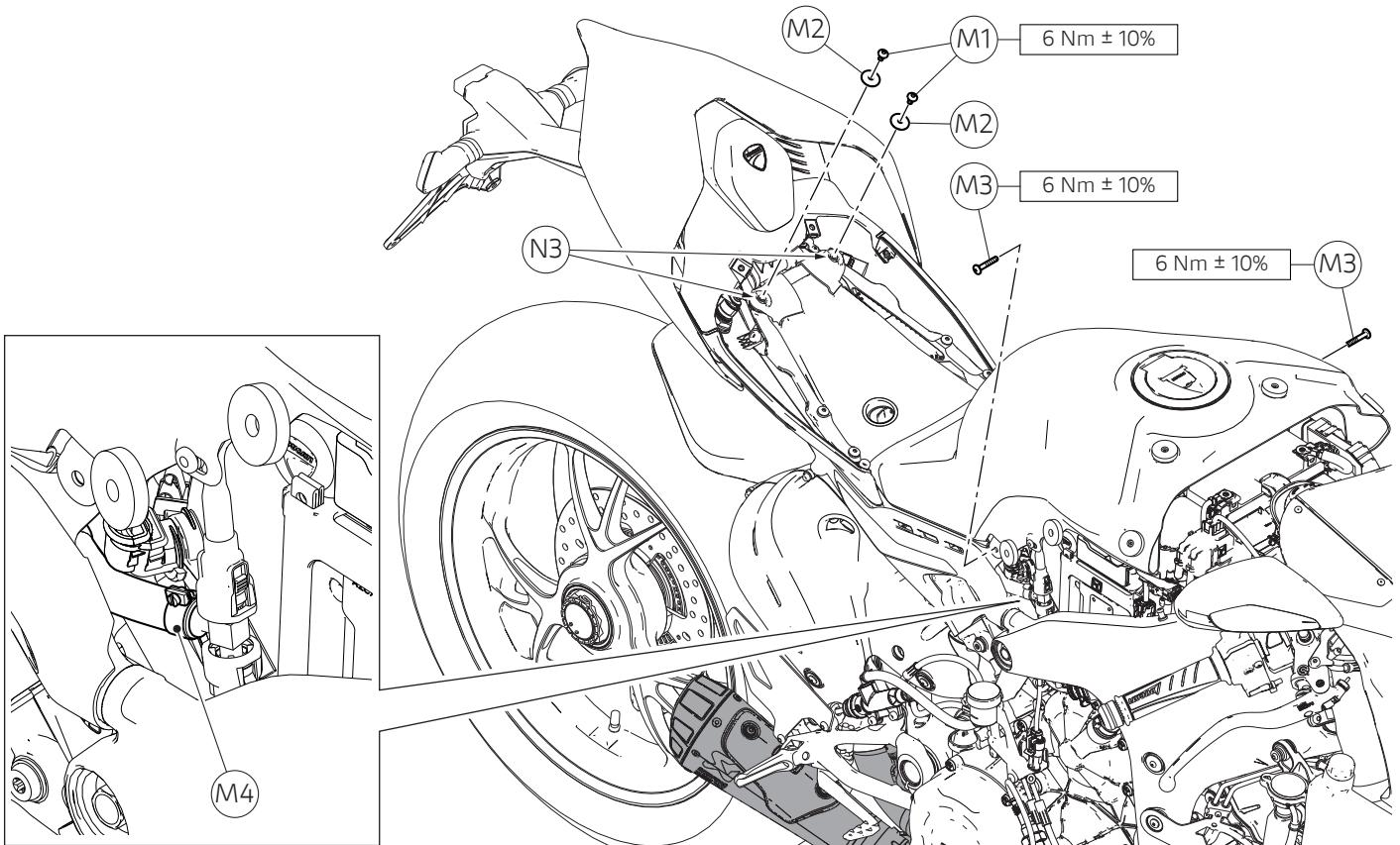
Impuntare le n.2 viti laterali originali (M3) e serrarle alla coppia di serraggio indicata. Inserire le n.2 rosette originali (M2) sulle n.2 viti originali (M1). Impuntare le n.2 viti (M1) sui n.2 cilindretti (N3) e serrarle alla coppia di serraggio indicata. Ricollegare il tubo alimentazione e serrare a mano la fascetta (M4).
