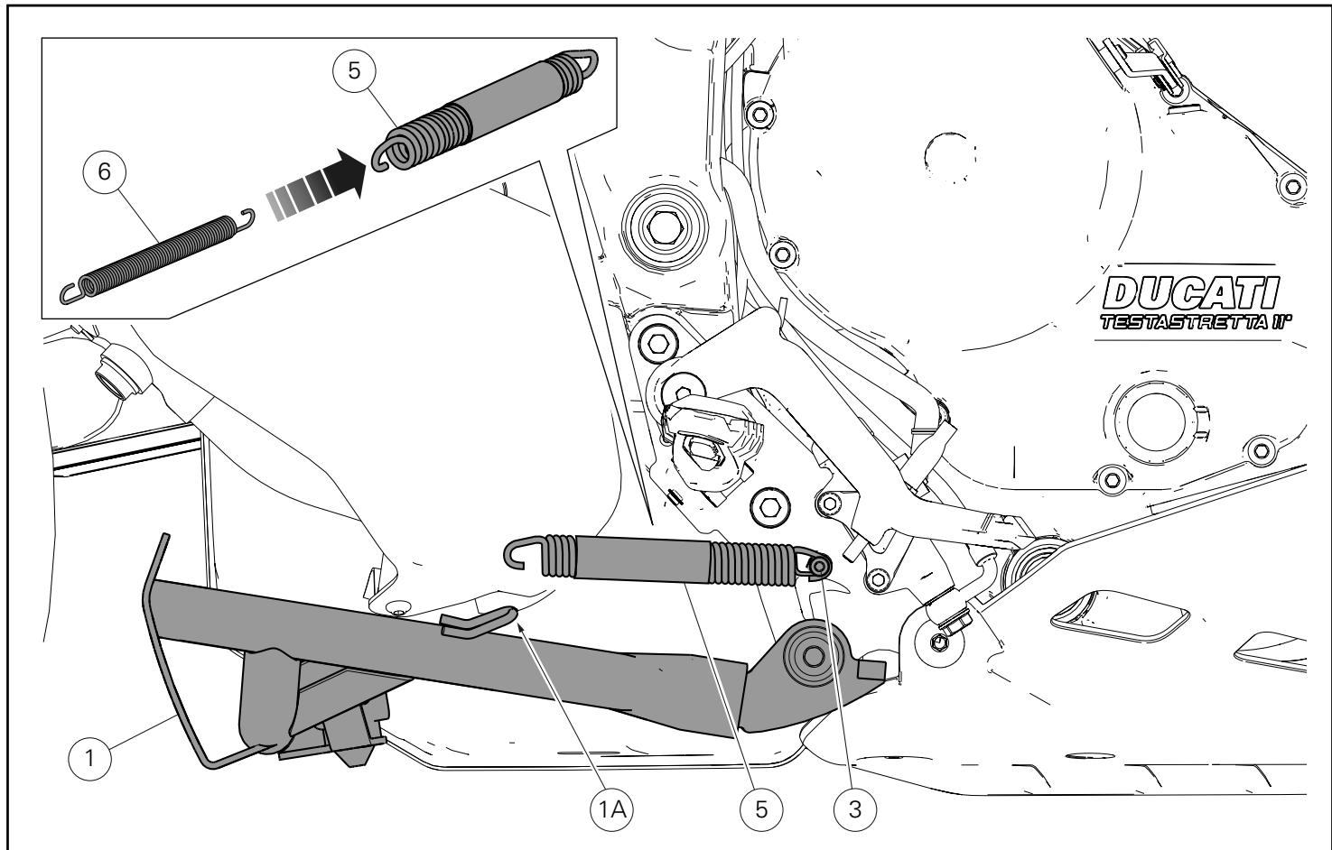
Introducir el muelle interno (6) en el interior del muelle externo (5) como ilustra la figura.
