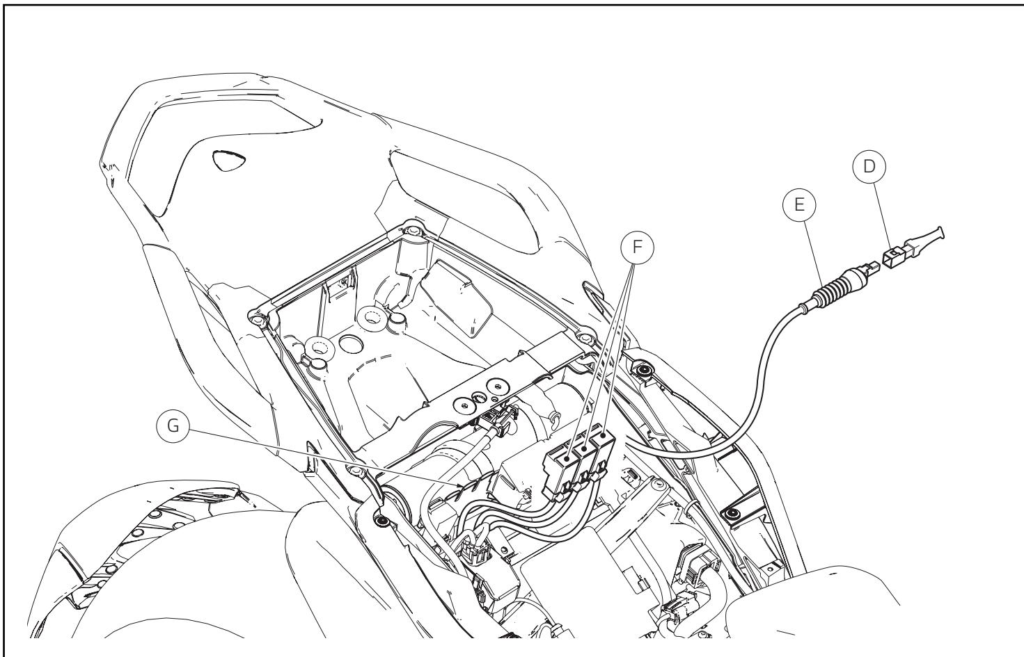
Rimuovere il tappo (D) dal connettore (E) del ramo cablaggio anti-furto. Sfilare i n.3 relè (F) dalle alette (G) della staffa supporto relè.
