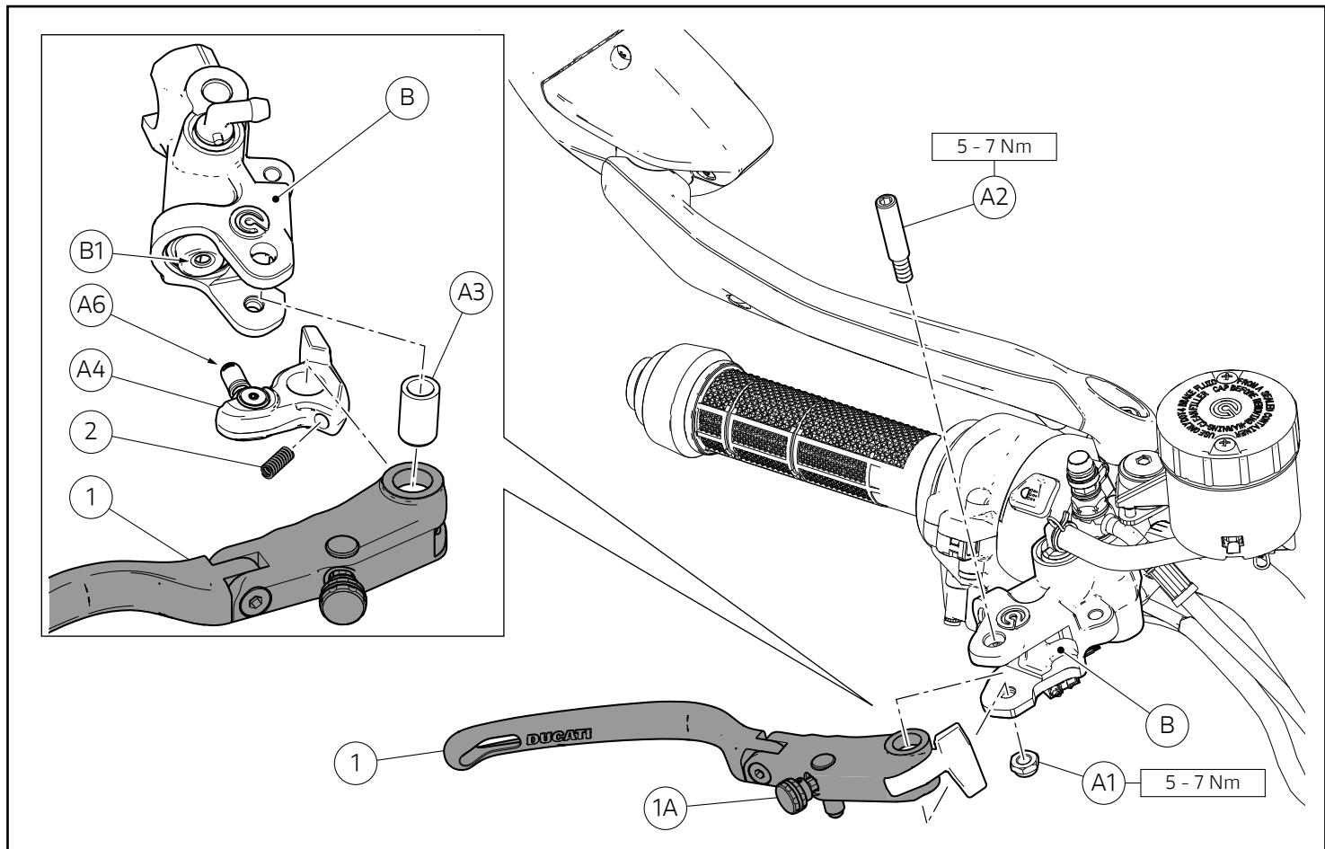
Inserire la molla (2) sul registro originale (A4). Montare il registro (A4) sulla leva freno anteriore (1), orientandolo come mostrato nel riquadro. Bloccare il registro (A4) inserendo la boccola originale (A3) nella leva freno anteriore (1).
