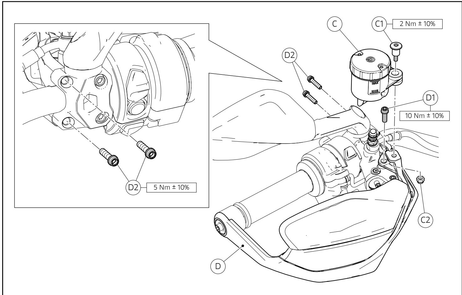
Riposizionare il paramano destro (D). Pulire ed eliminare eventuali residui di frenofiletti dalla vite originale (D1). Applicare LOCTITE 243 sulla vite originale (D1). Impuntare le n.2 viti (2) e la vite (D1). Serrare le viti alle coppie indicate.
